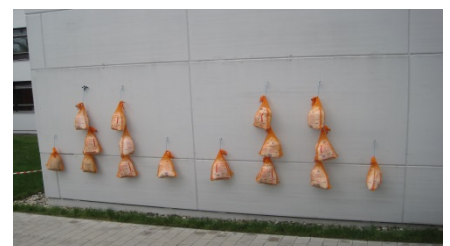
Belastungsversuch (Foto STBA)
